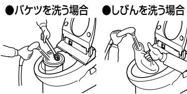
**開閉ハンドルを反時計回りに回し、シャワー開閉ボタンを押す。**
