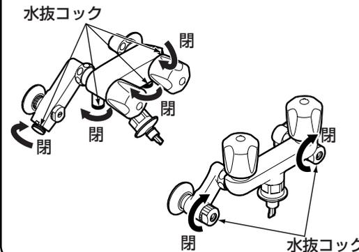
すべての水抜コックが閉まっていることを確認し、給水ホース継手を取り付け、湯側・水側ハンドル（水が出ない状態）および配管部の水抜栓を閉めてから通水を再開してください。
