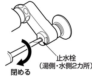
マイナスドライバーを差し込み、湯側・水側の止水栓を閉める。
