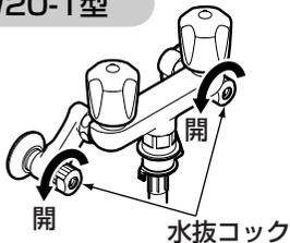
1. 配管部の水抜栓などにより通水を止めて、水抜きを行う。
