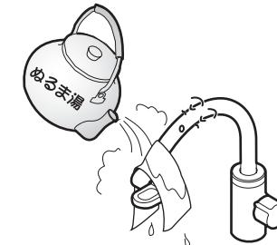
水抜きを行っても吐水口の網目やフィルターに付着した水滴が凍り、通水後も少しの間、水が出ない場合があります。そのときはタオルなどの布を巻き付け、しみこませるようにゆっくりとぬるま湯をかけてください。
