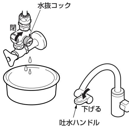
すべての水抜コックが閉まっていることを確認し、吐水ハンドルを下げて（水が出ない状態）から通水を再開してください。
