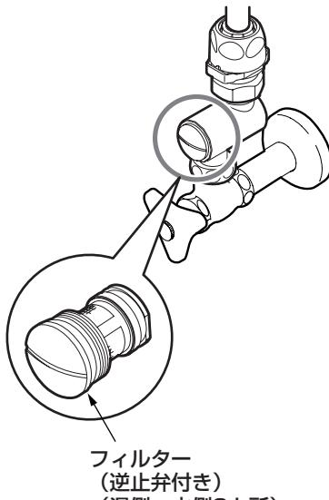
逆止弁が正常に機能しないと、状況によつては、水栓内部の湯が給水管に逆流するおそれがあります。逆流が生じた場合、給水管の破損による水漏れなどが生じる可能性があります。
