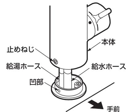
③ 水栓本体の止めねじを締めて水栓本体を固定する。
