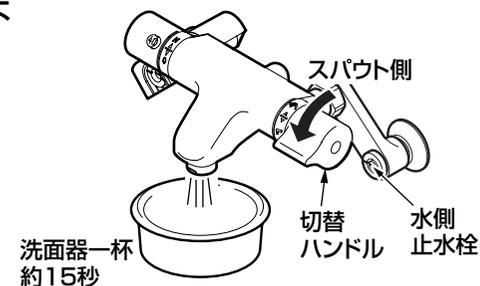
3. 安全ボタンを押しながら、温度調節ハンドルを上（湯側）いっぱい回し、2.と同じように湯側止水栓で流量を調節する。
