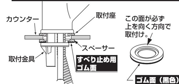
**[注意]** ・この取付座を取り付けた場合、水栓が取り付けられるカウンターの厚みは、22mm以下(『ちく5〜ず』の場合は24mm以下)になります。
