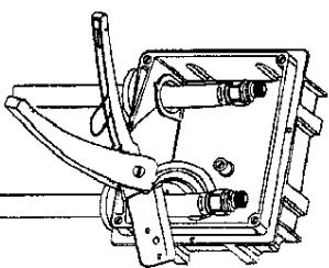
シールの位置までワントッチ継手を差し込み、抜けないと確認してください。
