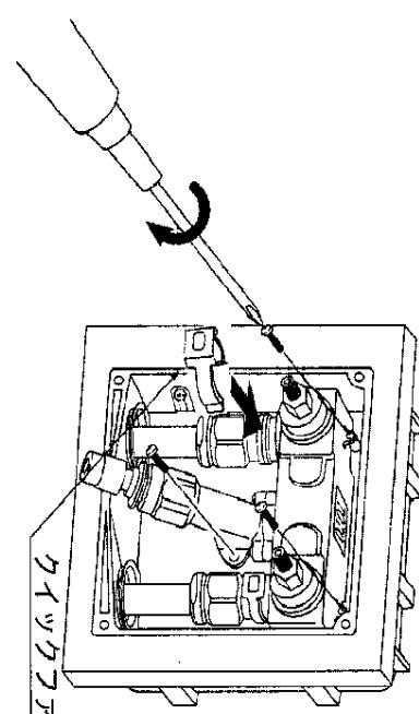
工程7の作業と同様に給水栓をボックスに固定してください。
