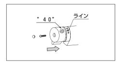
安全ボタンの"40"の文字とラインを合わせて温度調節ハンドルをはめ込み、小ねじを最後までねじ込んで固定キャップを取り付けてください。
