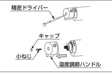
温度調節ハンドルが回らないように注意 してキャップ・小ねじを外してハンドル を抜き取ってください。
