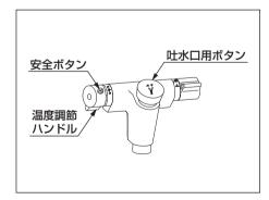
吐水口より(ただしTMF49C2型の場合は シャワーより)吐水させて温度調節ハンドルの 目盛りに関係なく40℃の湯が出る位置まで温 度調節ハンドルを回してください。
