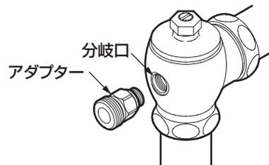
②アダプターにパッキン、分岐金具（ウォシュレットに付属）を取り付ける。
