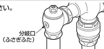
※ 分岐口のない場合は、分岐口付き止水栓本体を購入し、止水栓ごと取り替えてください。
