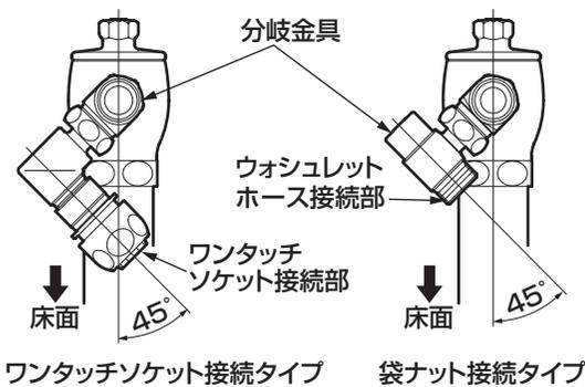
●袋ナット締め付けの際は、方向を確実にするために必ず分岐金具を手で保持してください。
