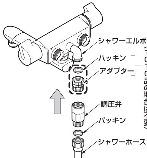
※調圧弁は工具で確実に締め付けてください。
