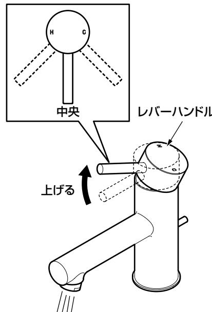
1. 配管部の水抜栓などにより通水を止めて、水抜きを行う。
