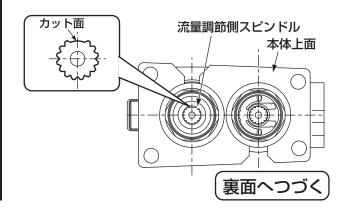
②ギアボックス上部のカット面を図の方向に合わせる。
