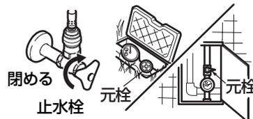
止水栓又は配管部の元栓を閉める。
