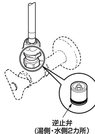
逆止弁が正常に機能しないと、状況によっては、水栓内部の湯が給水管に逆流するおそれがあります。
