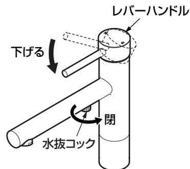
水抜コックが閉まっていることを確認し、レバーハンドルを下げて(水が出ない状態)から通水を再開してください。
