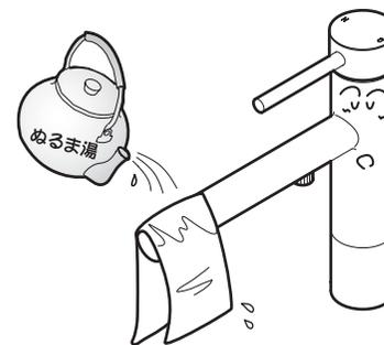
水抜きを行っても吐水口の網目に付着した水滴が凍り、通水後も少しの間、水が出ない場合があります。そのときはタオルなどの布を巻き付け、しみこませるようにゆっくりとぬるま湯をかけてください。
