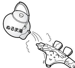
水抜きを行っても吐水口の網目やフィルターに付着した水滴が凍り、通水後も少しの間、水が出ない場合があります。そのときはタオルなどの布を巻き付け、しみこませるようにゆっくりとぬるま湯をかけてください。
