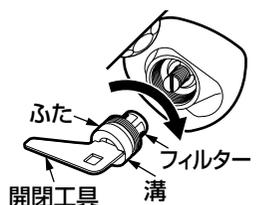
1. 開閉工具またはマイナスドライバーなどで湯側・水側の止水栓を閉める。
