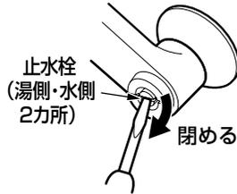
マイナスドライバーを差し込み、止水栓を閉める。
