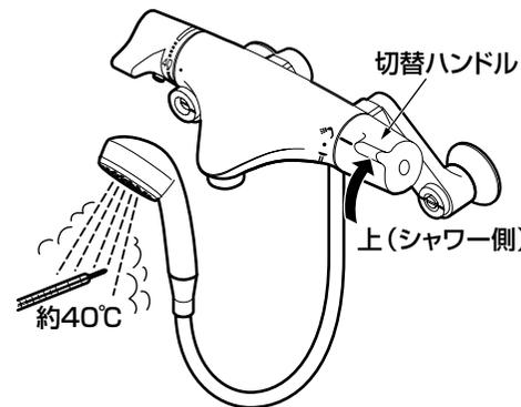
1. 給湯機の設定温度は希望の吐水温度より高めに設定する。
