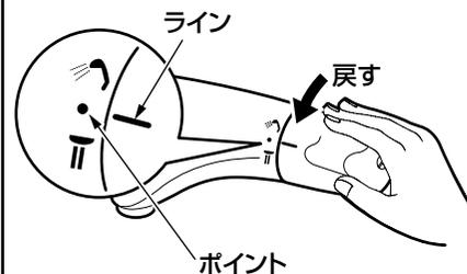
すべての水抜コック(3カ所)が閉まっていることを確認し、切替ハンドルのラインを水栓本体のポイントの位置まで(水が出ない状態)戻してから通水を再開してください。
