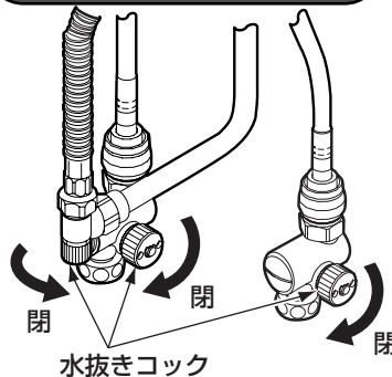
通水を再開する場合は、すべての水抜きコックが閉まっていることを確認し、レバーハンドルを下げて（水が出ない状態）配管部の水抜栓を閉め、元栓を開けてください。
