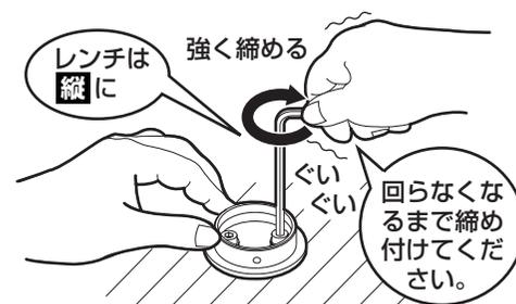
⑧ さらに六角棒レンチを横にしてボルトを**1回転増し締め**して確実に固定する。
