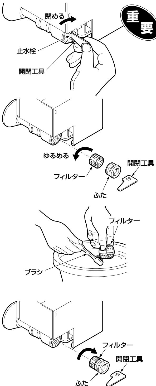
1. 止水栓を開閉工具で閉める。
