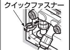
TOTOまたは各メーカーのAHS継手接続要領に従い、樹脂管が継手に確実に接続されていることを必ず確認する
