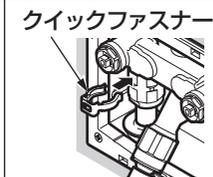
TOTOまたは各メーカーのAHS継手接続要領に従い、樹脂管が継手に確実に接続されていることを必ず確認する
