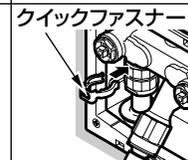
**TOTOまたは各メーカーのAHS継手接続要領に従い、樹脂管が継手に確実に接続されていることを必ず確認する**
