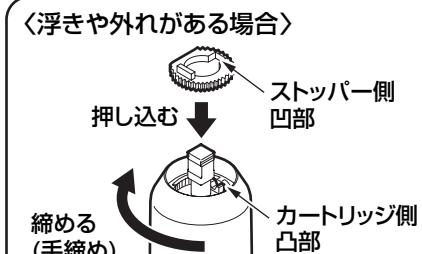
※カートリッジ押さえの歯とストップバーの歯が合わないときは、カートリッジ押さえを締め込む方向にて歯を合わせるように調整してください。
