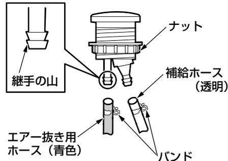
③カウンターの取付穴に固定する。補給口キャップを開け、カウンターの取付穴（φ58）に右図のように差し込み、ナットを手で締め付けます。
