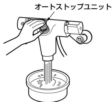
4. お好みの量に調節し、取り外しと逆の手順で取り付ける。
