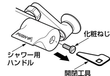
2. 化粧ねじの穴よりマイナスドライバーを差し込み、吐水量調節ねじを回す。
