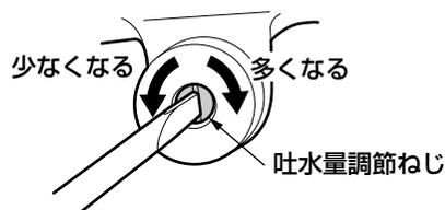
3. オートストップユニットの押しボタンを一度押して吐水量を確認する。
