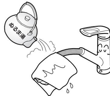
水抜きを行っても散水板の網目に付着した水滴が凍り、通水後も少しの間、水が出ない場合があります。そのときは、ハンドシャワーを引き出し、タオルなどの布を巻き付け、しみこませるようにゆっくりとぬるま湯をかけてください。
