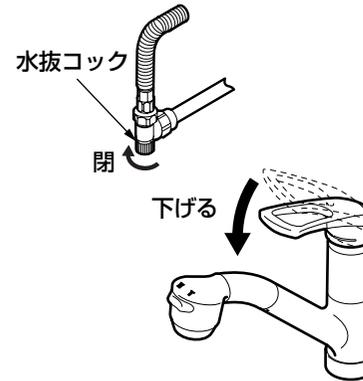
すべての水抜コックが閉まっていることを確認し、レバーハンドルを下げ（水が出ない状態）から通水を再開してください。
