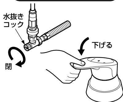
通水を再開する場合は、水抜きコックが閉まっていることを確認し、レバーハンドルを下げて（水が出ない状態）配管部の水抜栓を閉め、元栓を開けてください。
