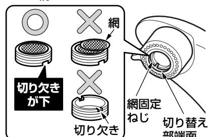
1.マイナスドライバーなどで網固定ねじを回して外し、網を外す。
