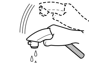
1. 配管部の元栓を閉め、水抜栓（配管部）を開ける。
