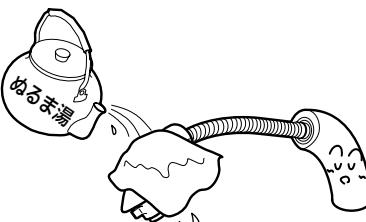
水抜きを行っても吐水口の網目やフィルターに付着した水滴が凍り、通水後も少しの間、水が出ない場合があります。そのときはハンドシャワーを引き出し、タオルなどの布を巻き付け、しみこませるようにゆっくりとぬるま湯をかけてください。
