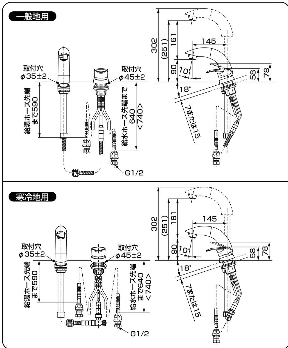
※ < > 内寸法は電気温水器セットタイプの寸法です。
