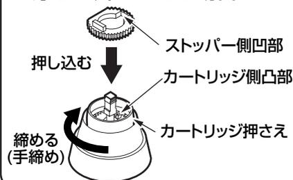
※カートリッジ押さえの歯とストッパーの歯が合わないときは、カートリッジ押さえを **締め込む方向** にて歯を合わせるように調整してください。
