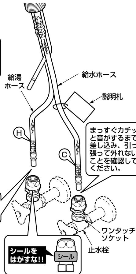
施工後、万一給水ホースを外した場合は、「**ホースの接続方法**」の説明札を確認のうえ、必ずワンタッチソケットと給水ホース内の残水を抜いてから給水ホースを差し込んでください。
