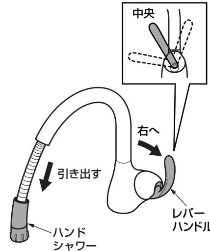
1. 配管部の水抜栓などにより通水を止めて、水抜きを行う。
