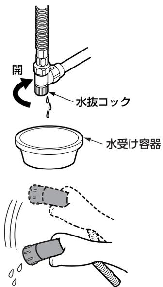
4. 水抜コックの下に水受け容器(洗面器など)を用意し、水抜コックを開ける。
