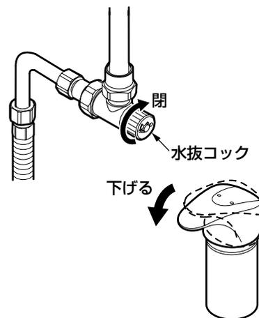
水抜コックが閉まっていることを確認し、レバーハンドルを下げて (水が出ない状態) から通水を再開してください。
