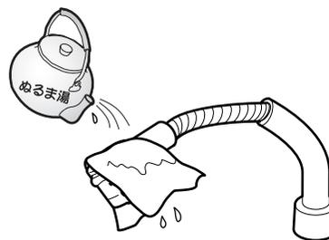
水抜きを行っても散水板や泡まつキャップの網目に付着した水滴が凍り、通水後も少しの間、水が出ない場合があります。そのときは、ハンドシャワーを引き出し、タオルなどの布を巻き付け、しみこませるようにゆっくりとぬるま湯をかけてください。
