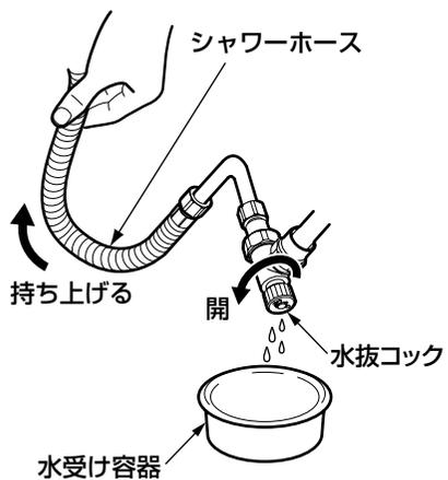
4. 水抜コックの下に水受け容器 (洗面器など) を用意し、水抜コックを開ける。
