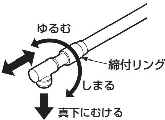
締付リングをゆるめてお好みの長さにして、締付リングを十分に締め付ける。
