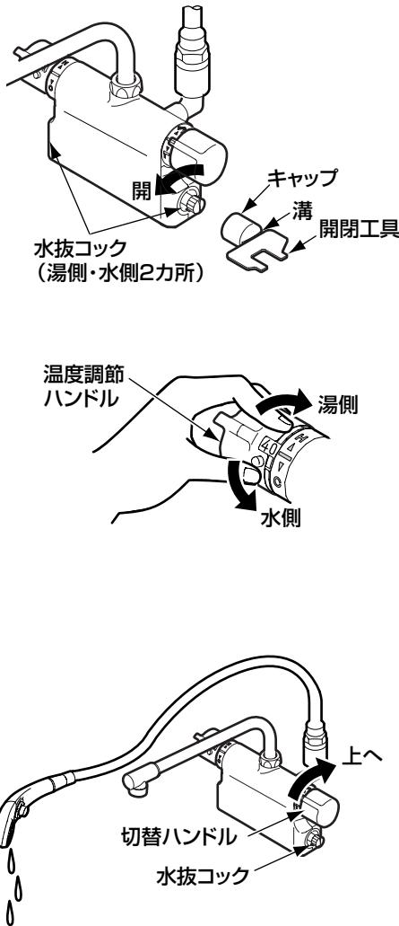
4. 開閉工具を溝に差し込み、キャップを外し、水抜コック(2カ所)を開ける。
