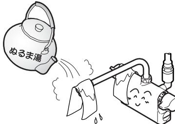
水抜きを行っても吐水口の網目やフィルターに付着した水滴が凍り、通水後も少しの間、水が出ない場合があります。そのときはタオルなどの布を巻き付け、しみこませるようにゆっくりとぬるま湯をかけてください。
