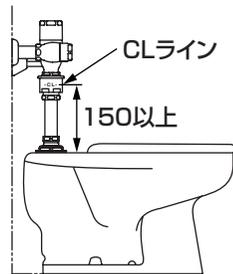
●本体を壁内などに設置する場合は、保守点検のために点検口を必ず設けてください。(点検口の最小寸法は右図を参照してください)
