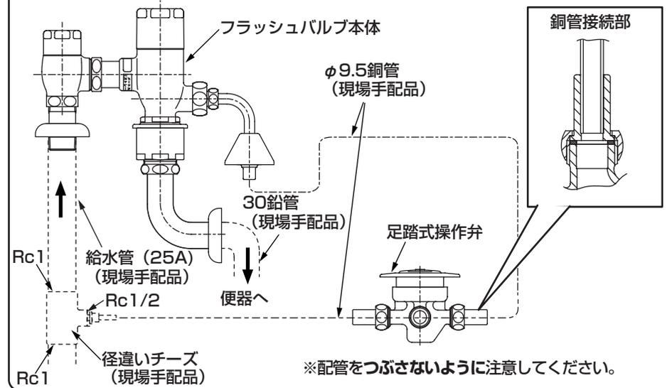
●サイホン・サイホンゼット・ブローアウト便器とリモコンフラッシュバルブ(壁給水壁排水形)とを組み合わせる場合は、便器を確実に洗浄するためフラッシュバルブを右図寸法内に取り付けてください。
