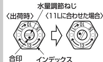
② 合印を合わせたあと、ハンドルを操作して確実に洗浄できるか確認する。
