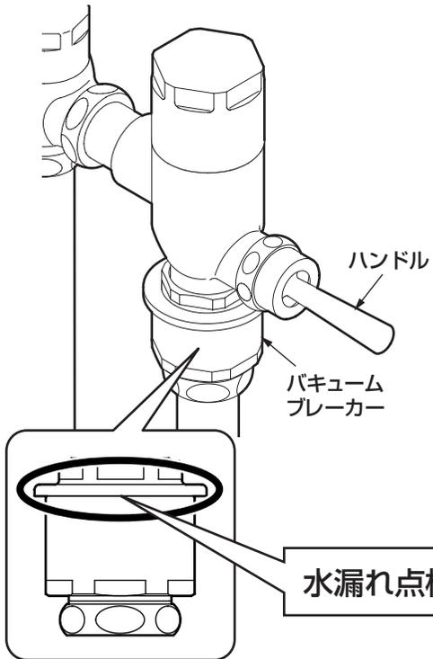
1. バキュームブレーカーの周囲を確認して、水漏れ跡がないかを確認する。
