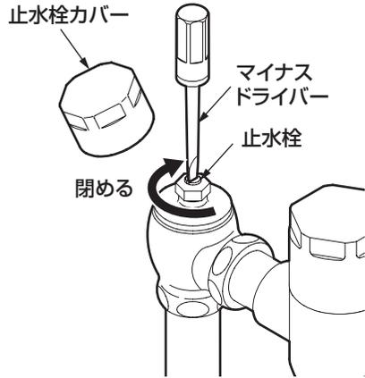
マイナスドライバーを差し込み、止水栓を閉める。
