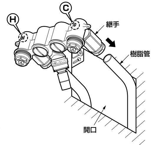
④水栓本体を壁内に収納し、水栓固定用ビス（2本）を締め付けて、水栓本体を固定板に取り付ける。
