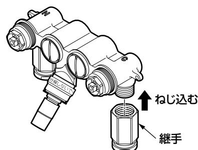
③樹脂管を上流側（ヘッダー側）から通管して開口から室内側に引き出し、継手と接続する。
