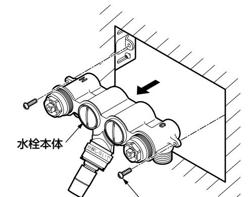
②水栓本体の給水管接続部にシールテープを巻き、継手をねじ込む。(2カ所)
