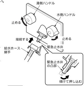
緊急止水弁部をメンテナンス する際は、スパウトが外れな いように上部ナット部をモン キーレンチなどで保持し、下 部ナット部をモンキーレンチ などで緩めて取り外してくだ さい。
