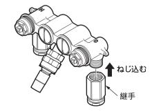
樹脂管を上流側(ヘッダー側)から通管して開口から室内側に引き出し、継手と接続する。
