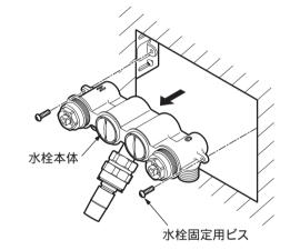
水栓本体の給水管接続部にシール テープを巻き、継手をねじ込む。 (2ヵ所)
