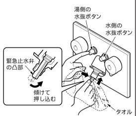
5. 水抜き完了後は、必ず湯・水両方のハンドルを「止」の位置まで回す。(水が出ない状態)
