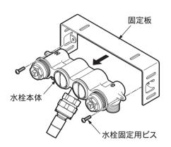
取付高さを考慮して、当木などを設け、固定板の側面2ヵ所、上面2ヵ所を木ねじで取り付ける。
