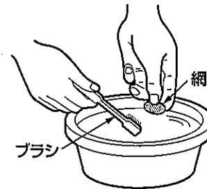
1. マイナスドライバーなどで網固定ねじを回して外し、網を外す。
