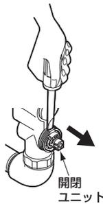
●取り外す時にユニットのスピンドル方向がA又はBのどちらになっているかを確認してください。取り付けの際、スピンドル方向が逆になっていると取り付けできませんので必ず確認してください。
