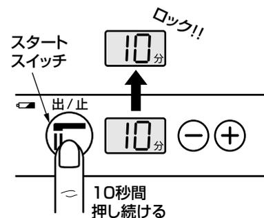
水が止まっている状態でスタートスイッチを押し続け、水を出します。10秒間押し続けると水が止まり、設定時間を変更できないようになります。同じ操作をもう一度行うと設定時間を変更できるようになります。
