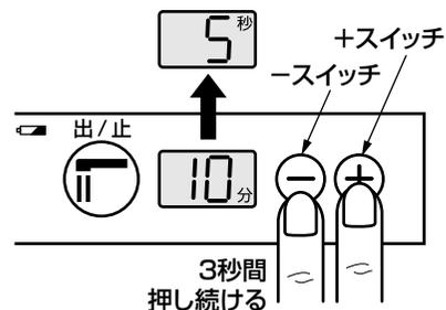
+スイッチを同時に3秒以上押し続けます。時間表示部が"5秒"に切り替わります。+スイッチで時間の変更ができます。もう一度+スイッチを同時に3秒以上押し続けると"10分"に切り替わります。
