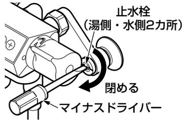
マイナスドライバーを差し込み、止水栓を閉める。
