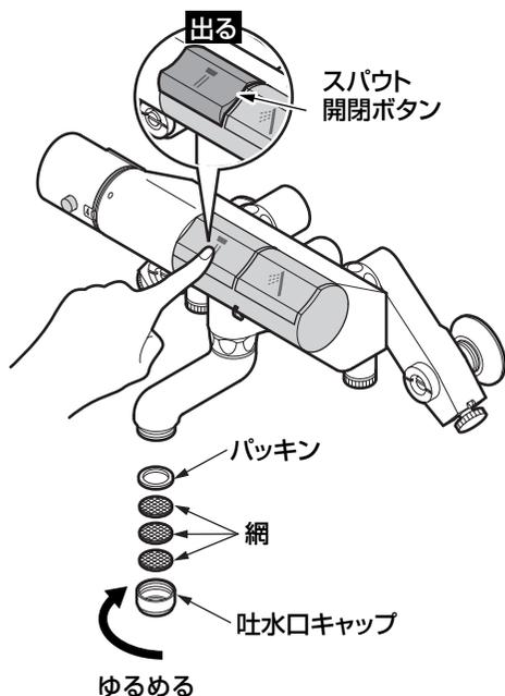
1. 配管部の水抜栓などにより通水を止めて、水抜きを行う。
