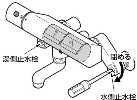
マイナスドライバーを差し込み、湯側・水側の止水栓を閉める。
