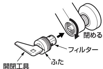
1. 開閉工具で湯側・水側の止水栓を閉める。
