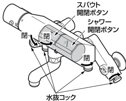
すべての水抜コック(5カ所)が閉まっていることを確認し、スパウト開閉ボタン・シャワー開閉ボタンを押して(水が出ない状態)から通水を再開してください。
