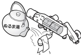
水抜きを行っても吐水口の網目やフィルターに付着した水滴が凍り、通水後も少しの間、水が出ない場合があります。そのときはタオルなどの布を巻き付け、しみこませるようにゆっくりとぬるま湯をかけてください。
