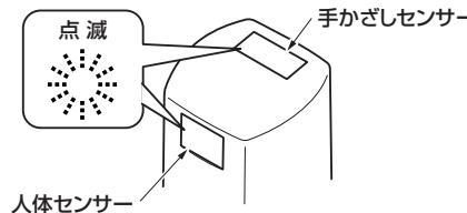
バックアップ電池が切れると、人体センサーおよび手かざしセンサーの感知表示ランプが4秒間隔で同時に点滅し、洗浄機能が停止します。
