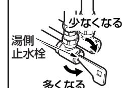
**給水圧力は給湯圧力より必ず高くするか、同圧にする**
