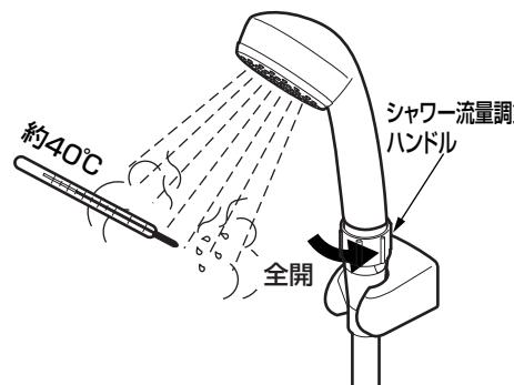
1. 給湯機の給湯温度を設定する。
