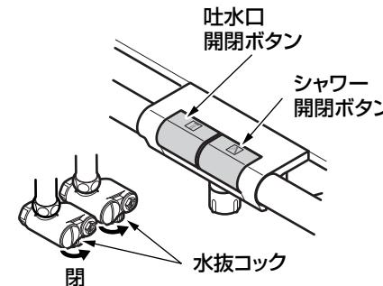
すべての水抜コックが閉まっていることを確認し、吐水口開閉ボタン・シャワー開閉ボタンを押して（水が出ない状態）から通水を再開してください。
