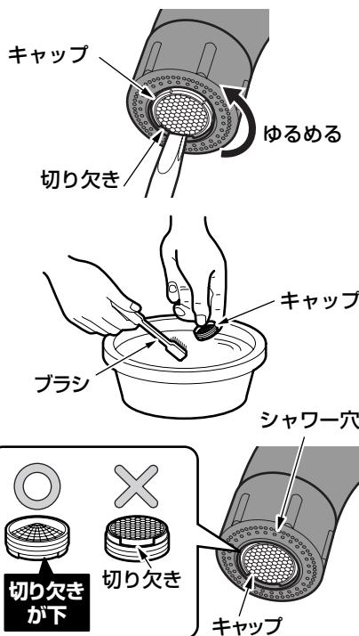
1.マイナスドライバーなどをキャップの切り欠きに差し込み、回して外す。
