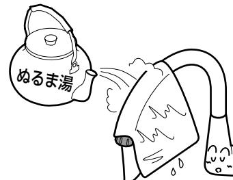
水抜きを行っても吐水口の網目に付着した水滴が凍り、通水後も少しの間、水が出ない場合があります。
