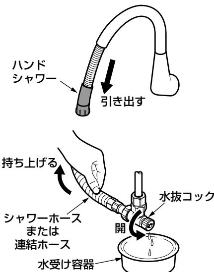
1. 配管部の水抜栓などにより通水を止めて、水抜きを行う。
