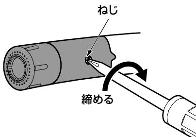
プラスドライバーでゆるんだねじを締める。
