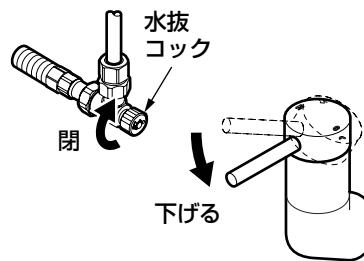
水抜コックが閉まっていることを確認して、レバーハンドルを下げて（水が出ない状態）から通水を再開してください。
