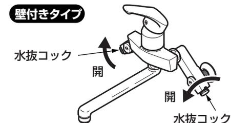
4. 水抜き完了後は、必ず水抜コックを閉め、レバーハンドルを下げる。
