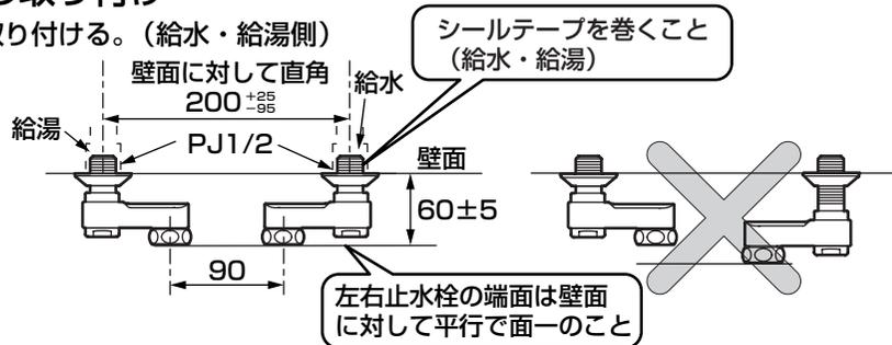
※寒冷地用の場合は取付脚の水抜コックが本体よりも上になると、水抜きができませんので必ず下になるように取り付けてください。
