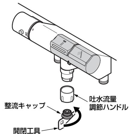
11. 水抜き完了後、吐水流量調節ハンドルを整流キャップで取り付ける。
