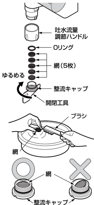
1. 開閉工具で整流キャップを回し、外す。
