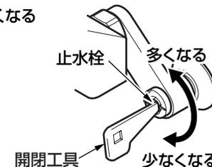
4. 安全ボタンを押しながら、温度調節ハンドルを上(湯側)いっぱい回し、3.と同じように湯側止水栓で流量を調節する。
