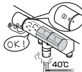
万一、凍結した場合は、温度調節ハンドルの目盛り"40"と吐水温度が確認してください。凍結すると、設定温度がずれてやけどをするおそれがあります。
