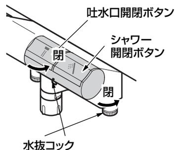
すべての水抜コックが閉まっていることを確認し、吐水口開閉ボタン・シャワー開閉ボタンを押して(水が出ない状態)から通水を再開してください。
