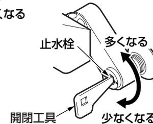
4. 温度調節ハンドルの安全ボタンを押しながら上(湯側)いっぱい回し、3.と同じように湯側止水栓で流量を調節する。
