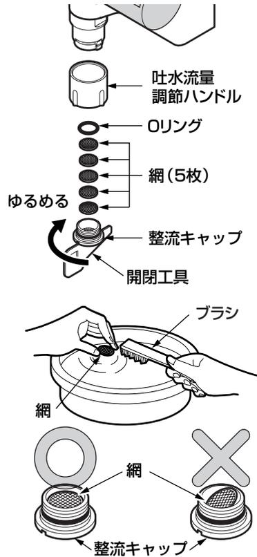
1. 開閉工具で整流キャップを回し、外す。
