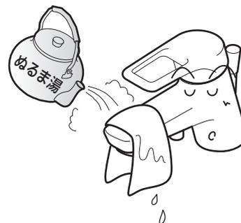
水抜きを行っても吐水口の網目に付着した水滴が凍り、通水後も少しの間、水が出ない場合があります。
