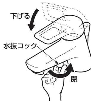
水抜コックが閉まっていることを確認し、レバーハンドルを下げて(水が出ない状態)から通水を再開してください。
