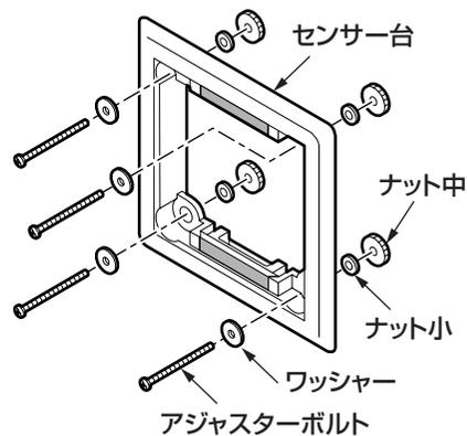
②アジャスターボルトが取付板の穴に入るように、センサー台を開口部にはめる。
