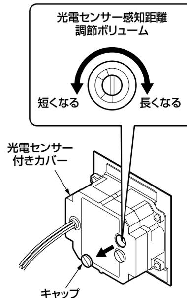
1. 光電センサー感知距離調節ボリュームのキャップを外す。
