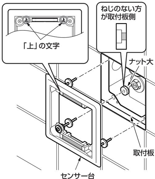
③センサー台の位置を調整したあと、センサー台をアジャスターボルトで固定する。
