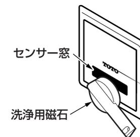
使用者に操作方法がわかるように、光電センサーに近い壁面にラベル貼り付けてください。
