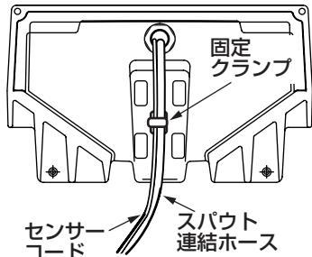
⑤洗面器をバックハンガーに取り付け固定する。
