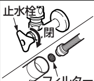
止水栓 閉 フィルター
